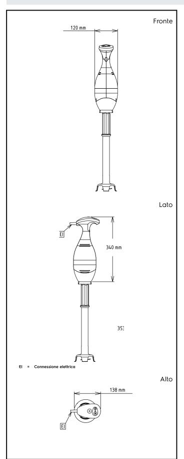
**Elettrico** Tensione di alimentazione: 220-240 V/1 ph/50/60 Hz Potenza installata max: 0.45 kW Watt totali: 0.45 kW
